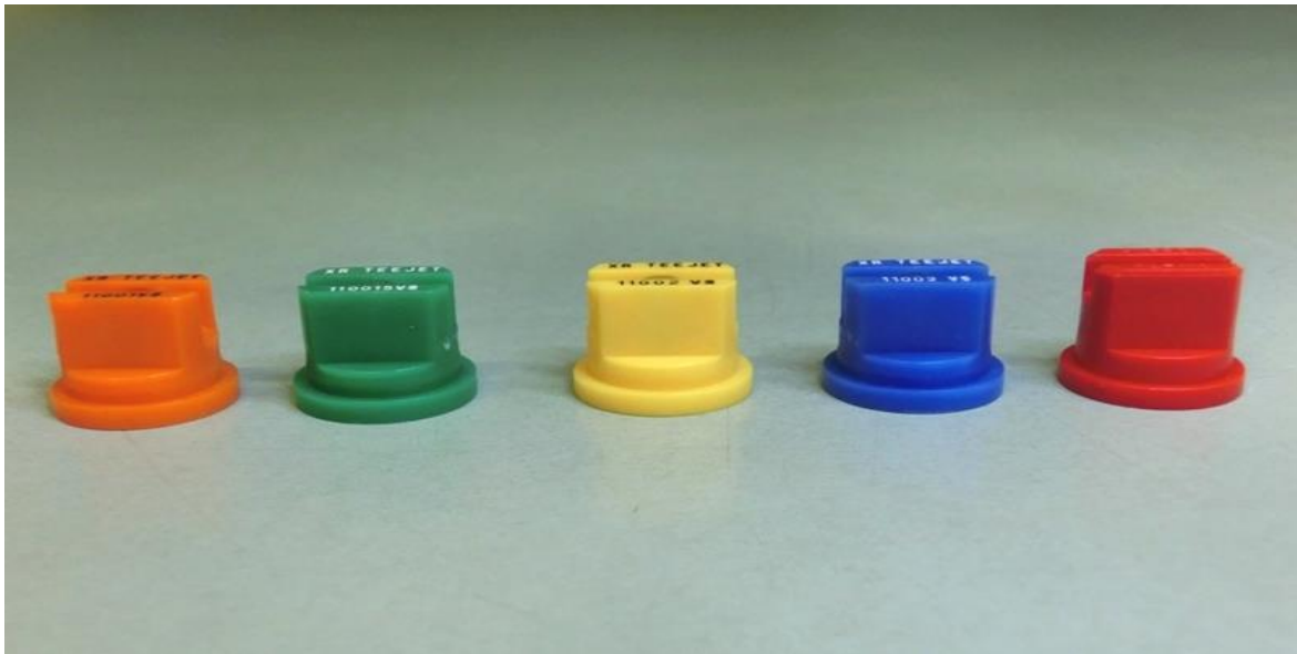
Fot. 48. Zgodnie z normami ISO kolor rozpylacza koduje jego wydajność cieczy w ciągu 1 minuty. Rozpylacze o większym wypływie cieczy wytwarzają krople o większych rozmiarach, gdy pracują pod tym samym ciśnieniem. Od lewej rozmiar: 01, 015; 02; 03 i 04
