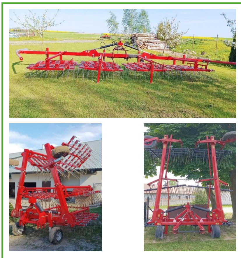
Fot. 3. Różne typy brony chwastownika jako podstawowe maszyny do pielęgnacji zbóż w gospodarstwach ekologicznych
